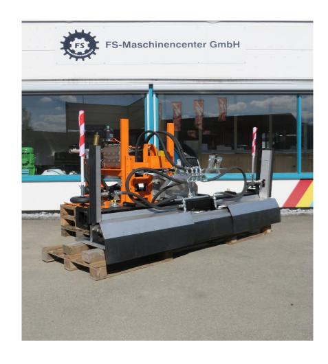
INOX-Hochdruckdüsenrohr mit je 4 Washjet-Düsen 4005,
